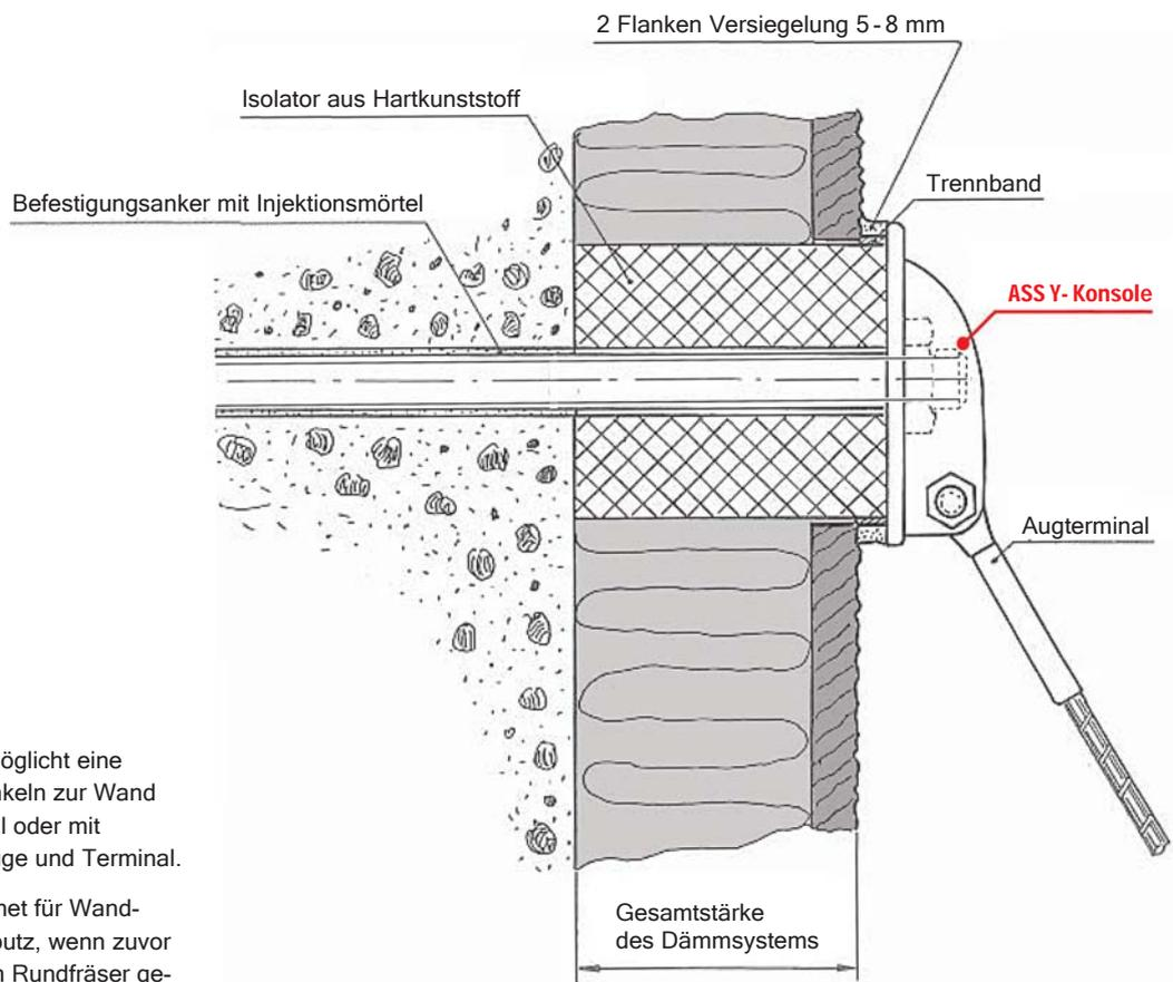
Die ASS Y-Konsole ermöglicht eine Befestigung in allen Winkeln zur Wand für Seile mit Augterminal oder mit Wantenspannern mit Auge und Terminal.
