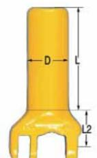
**Achtung** → Bei der mechanischen Bearbeitung des Schaftes darf der mit D\*\* angegebene Durchmesser unter Berücksichtigung der zulässigen Tragfähigkeit nicht unterschritten werden. Die Gewindelänge sollte 1,5 x D min nicht unterschreiten.
