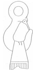
Bild D.1 - Darstellung einer unsachgemäßen Anpassung eines Schlaufengurtbandes an einen Haken mit zu kleinem Radius
